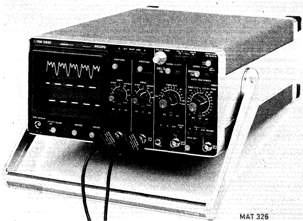
Fig. 1.1. Oscilloscope double trace portatif v.h.f. PM 3240.
